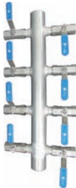
2" Kompaktverteiler 8-fach für Warmwasser-Begleitheizung Sonderausführung, Material: 1.4571, Artikel-Nr. 26422504
